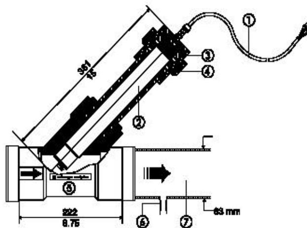
图9 63mm ( DN50 ) Y型部件安装
