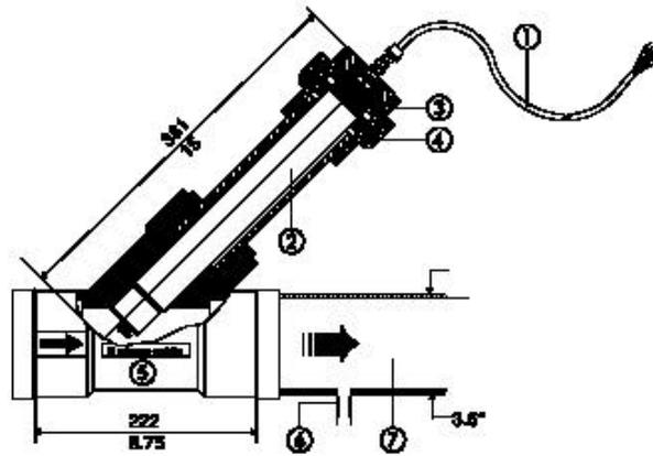
图10 英制 3 " Y型部件安装
