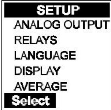
求平均值的目的是为了能获得较平稳的信号，而不至于因为工艺中某些短时间的波动而造成测量数据显示中出现极不稳定的变化。求平均值的过程相当于定义了一个波动缓冲器，在测量中按照给定的时间间隔进行给定次数的测量。求平均值的过程同时控制测量结果的显示和电流输出。两个通道的求平均值情况可以有所不同。
