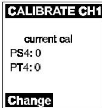
7、在“Change”选项下再次按左键，当前PT值会变亮。使用右键改变数字位数 按回车键确认更改结果并将光标移至下一个待修改处。将PT值改变为以所选工程单位表示的、您所估计的当前工艺中此处悬浮固体浓度值。完成上述操作后按回车键确认，屏幕上会显示“current cal”。
