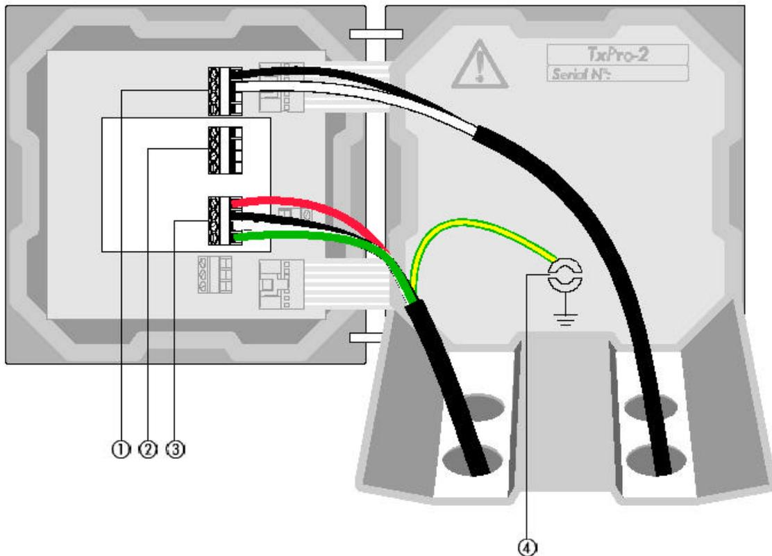
图12 电流输出和传感器的连接
