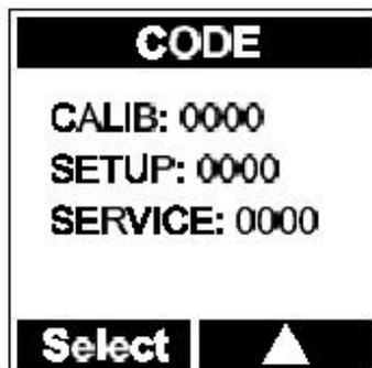
为了对某一菜单实现保护，您必须更改该菜单缺省设置。使用左键选择菜单，使用右键改变密码的每一位数字，使用回车键确认并移动光标。如果您将某一菜单的密码缺省设置值进行了更改，则下一次进入该菜单时必须输入正确的密码。如果您忘记了密码的话，请同时按退出键和回车键进入“CODE”菜单。
