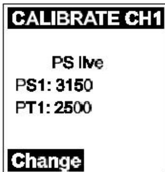
6、在“Change”选项下再次按左键，当前PT 1值会变亮。将PT 1值改变为以所选工程单位表示的、您所估计的当前工艺中此处悬浮固体浓度值。使用右键改变数字位数，按回车键确认更改结果并将光标移至下一个待修改处。完成上述操作后按回车键确认，屏幕上会显示“current cal”。
