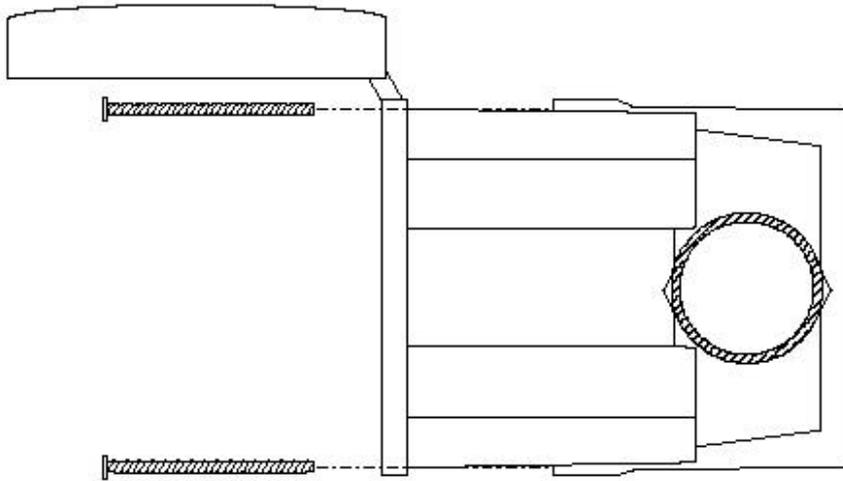
图2 管道式安装
