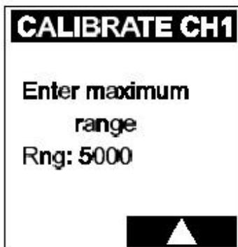
10、再次按回车键进入最大测量范围屏幕，以所选工程单位表示、输入最大测量范围值，通常该浓度值时电流输出为20 mA。此情况下，变送器将会根据PT 1值数据外推出一条校准标准曲线。注意，输入的最大测量范围值应不小于或等于PT 1值。
