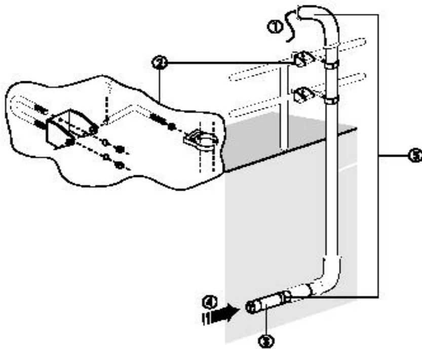
图8 浸没式传感器的安装情形
