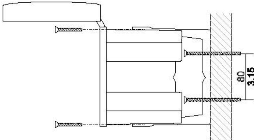
图3 壁挂式安装
