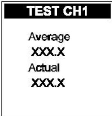
“**TEST**”（测试）：您可以同时观察平均测量结果和瞬时测量结果。按**左键**使光标滚动至“**TEST**”选项，然后按**回车键**确认。完成操作后，按**退出键**返回上一级菜单。
