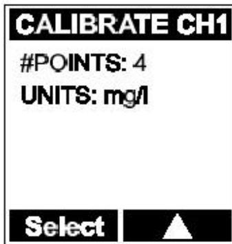
5、校准点值PT 0~PT 4与探头信号值PS 0~PS 4必须要呈依次增大的趋势，即：PT 2 > PT 1、PS 2 > PS 1。因为您将要对从工艺取的样及其不同倍数的稀释样进行校准，而且要从最高浓度的校准点开始。按回车键直至所要校准的最高浓度的校准点出现——PS 2、PS 3或者PS 4，具体结果取决于步骤2中所选取的校准点的数量。
